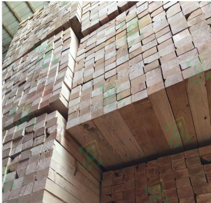
建筑木方，俗称方木，别称有木方，建筑木方，建筑方木，口料，模板支撑，方木支撑等等，每个地方的叫不太一致。它是指将木材原木根据建筑工地上的实际需要，把原木切割成一定规格形状的方形条木，用于工地土建支模用，结构施工中的模板支撑，起到一个固定模板的用途及屋架用木材。商品材是按照国家制定的木材标准进行加工后，供出售或调拨，以满足国民经济各部门建设和人民生活需要的木材。商品材指的是一株树或一个林分经过采伐和造材之后，生产的可作为商品出售的经济材和薪材总和。
